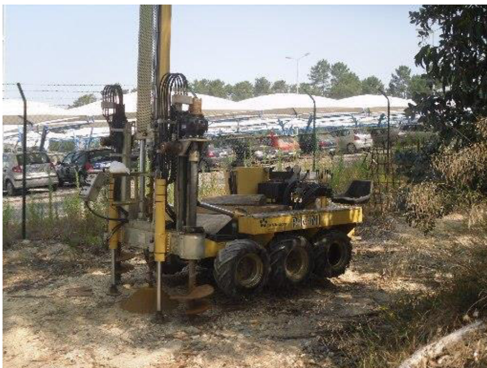
Figura 5 – Equipamento de execução dos trados (Pagani, modelo TG 73 – 200), no local onde foi executado o trado T5.
