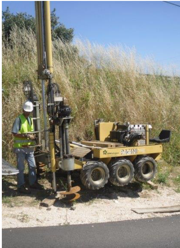
Figura 7 - Equipamento de execução dos PDSP (penetrómetro Pagani, modelo TG 73–200) durante a execução do PDSP1.
